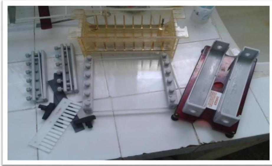
الشكل (08) : مكونات جهاز الفصل
